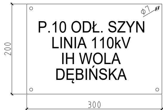
Opis na szafce napędu odłącznika szynowego
