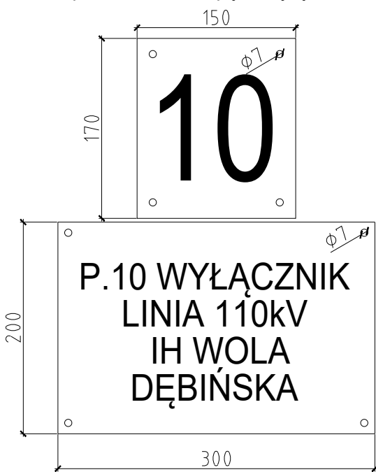
Opis na szafce napędu wyłącznika
